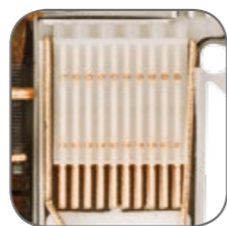
Две дугогасительные камеры для надежного гашения дуги
