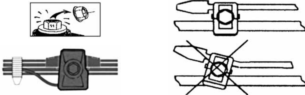
Рис. Схема установки ответвительного зажима
