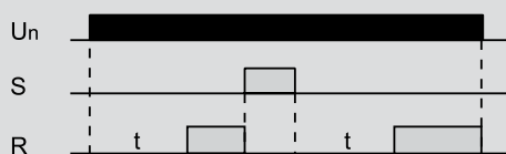
Диаграмма работы реле задержки включения ORT-A
